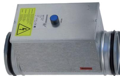
Die Heizregister müssen in einem Mindestabstand von 1 m nach dem Ventilator angeordnet werden. Die Luftgeschwindigkeit im Heizregister muss mindestens 1,5 m/s betragen
