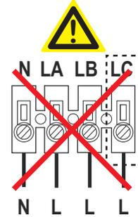
Bei *gleichzeitiger* Verwendung zweier Wicklungen (z.B. LA + LB) bzw. Anschluss des Schutzleiters (PE) an einer der Klemmen LA oder LB werden die Motorwicklungen thermisch überlastet.
