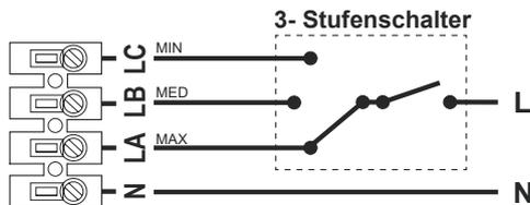
Mit Transformator oder Drehzahlsteller
