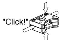
Beide Gehäuse-Halbschalen sind deckungsgleich mit den Montagestiften zu verbinden.
